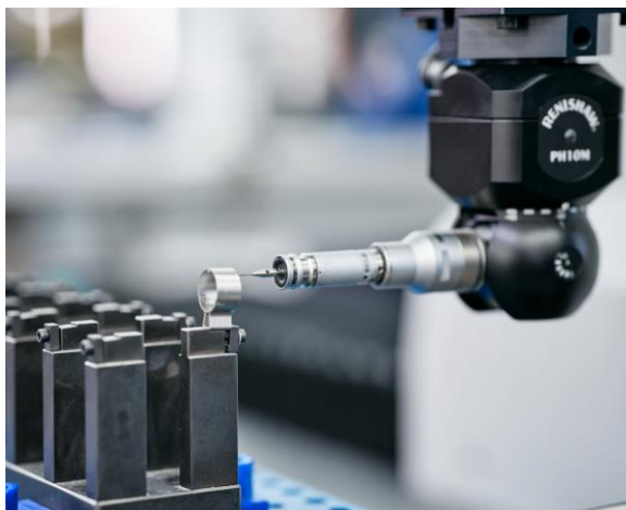
Abbildung 1: mit modernen Messmaschinen wird die Genauigkeit und Qualität von MIM-Komponenten sichergestellt
